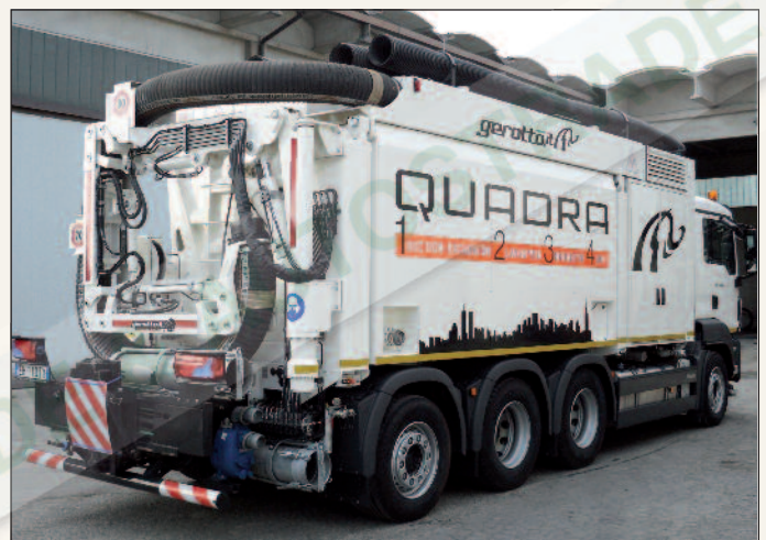
Figura 1 - L'escavatore a risucchio
